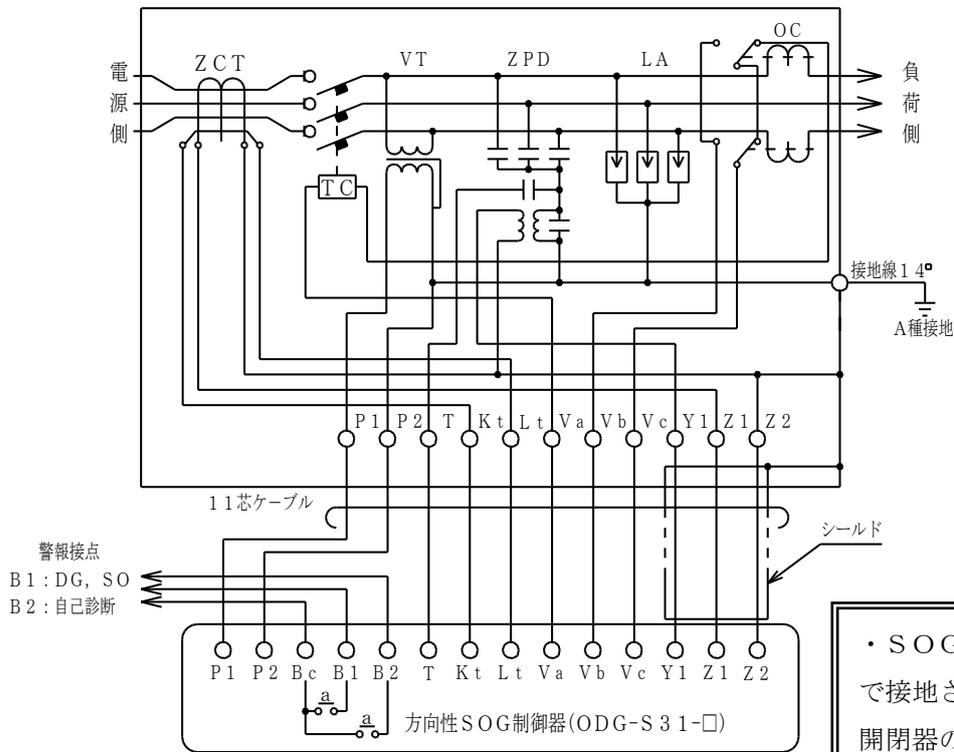
・SOG制御器は開閉器内部で接地されておりますので、開閉器のみ接地して下さい。
