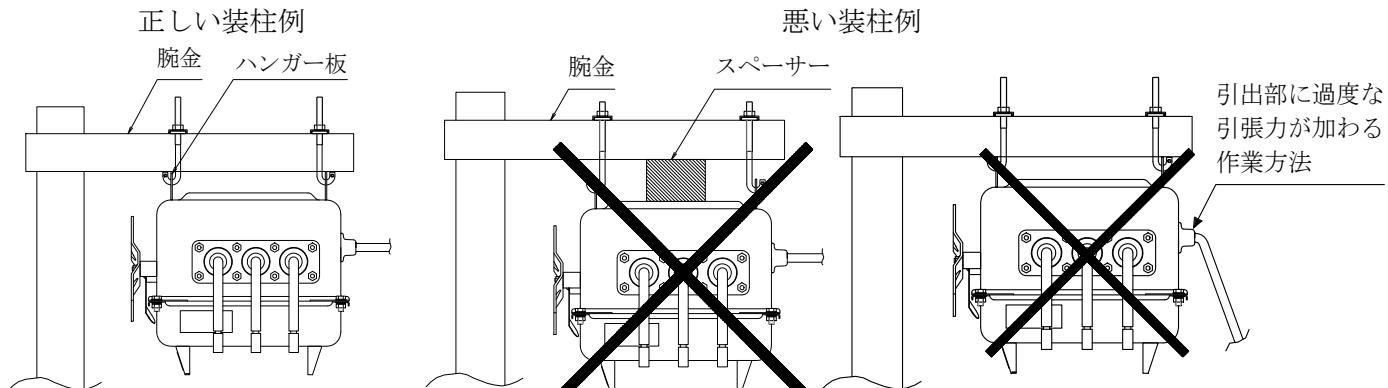
※悪い装柱例のように取付けた場合、ケースが変形し、内部構造に悪影響を与える恐れがあります。また、装柱の過程で制御ケーブル引出部に過度な引張力が加わるような作業を行った場合、制御ケーブル引出部の破損により気密不良になる恐れがあります。
