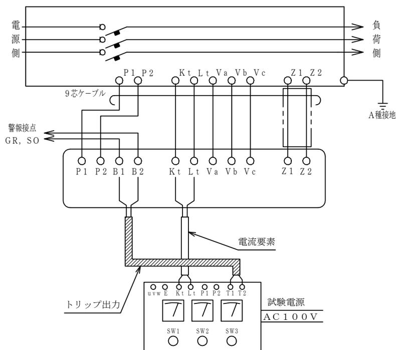
試験端子の接続方法は試験器により異なりますので、試験器の取扱説明書を参考にしてください。
