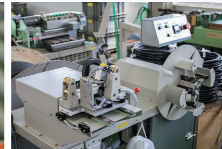
制御ケーブル自動計測設備
